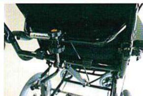
調節ネジを回すことで背カーブに合わせシートの角度を簡単調節
